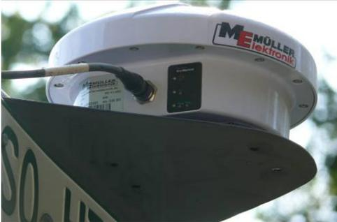
notwendige Genauigkeit des Parallelfahrssystems zu erreichen, wird eine RTK-Station genutzt, wodurch Abweichungen von der vorgegebenen Fahrlinie auf +/- 2cm reduziert werden können. Um die Betriebsgenauigkeit und den Bedienkomfort zu steigern, wurde der Schlepper mit einem integrierten Lenksystem ausgestattet, welches direkt mit der Lenkhydraulik verbunden ist.
