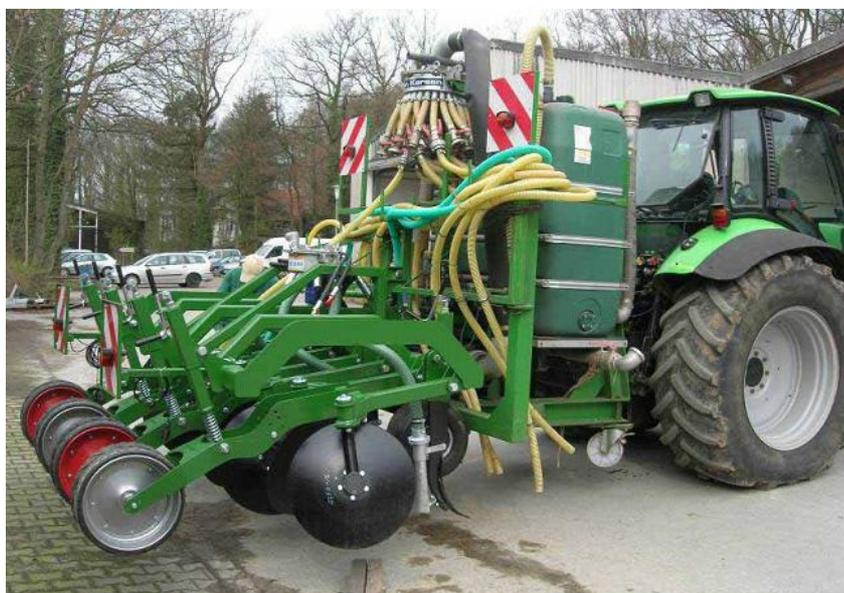
**Abbildung VI /7: Versuchsgerät zur Gülledüngung**
