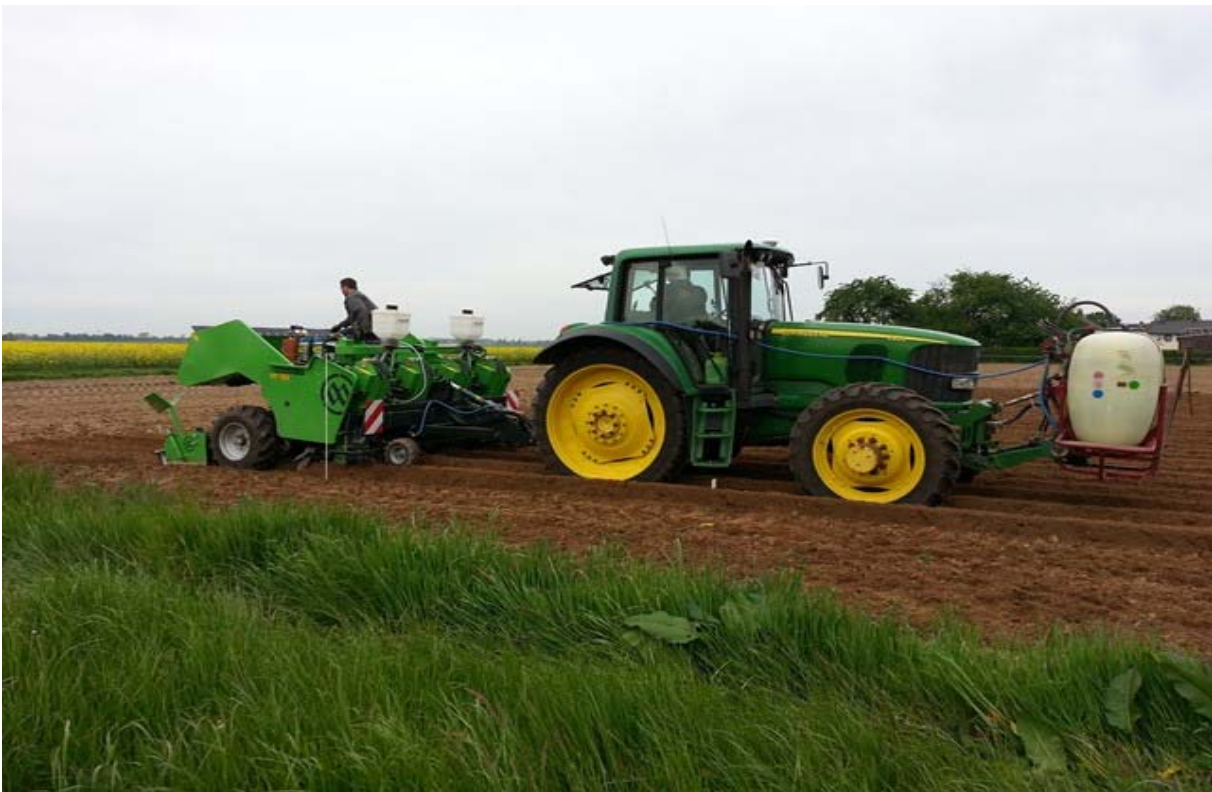
aufgebauter Granulatstreuer und Beizvorrichtung (Foto: Dr. M. Benker)
