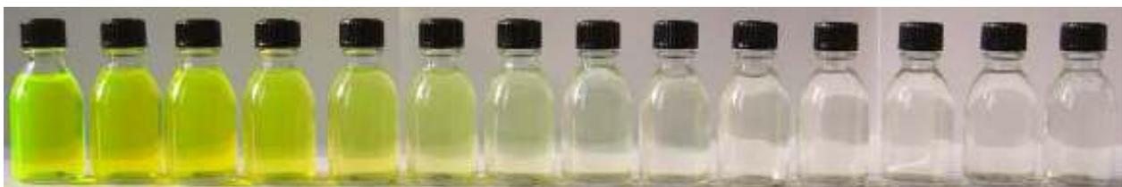
Durch kontinuierliche Zufuhr von Klarwasser kann die Konzentration im System (Spritzeleitungen) drastisch verdünnt werden. Von links (Spritzebrühe) bis rechts (gereinigt) lässt sich die Konzentration der nicht verdünnbaren Restmenge auf <1% der Brühekonzentration verdünnen. (Bild: Harald Kramer, Untersuchungen zur Gerätereinigung im Rahmen des TOPPS-Projektes).
