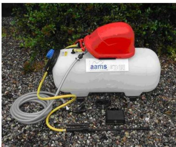
**Hersteller liefern schon zusätzlich Sets für die Innen- und Außenreinigung kleinerer Feldspritzen und Sprühgeräte auf dem Feld (Behälter + Elektropumpe + Innenreinigungsdüse + Spritzlanze)**
