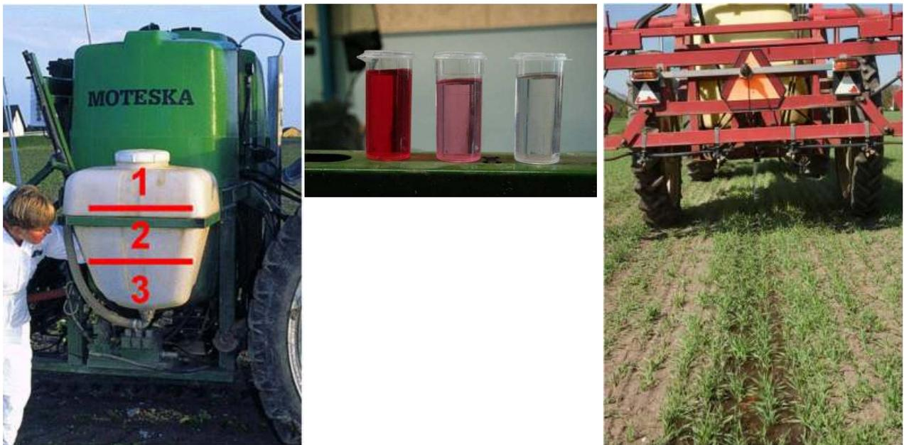
Bei der Innenreinigung ist mit der gleichen Wassermenge ein dreifaches Spülen effektiver als ein Einmaliges. Dreifaches Spülen ermöglicht auch das Ausbringen der verdünnten Restmengen im Anschluss an die Reinigung auf dem Feld – diese müssen aber während der Fahrt und nicht im Stand ausgebracht werden (Bilder: Eskil Nilsson und Jens Tønnesen).
