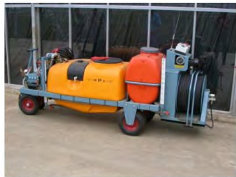
Steigrohr ist entscheidend nicht die Skalierung am Behälter
