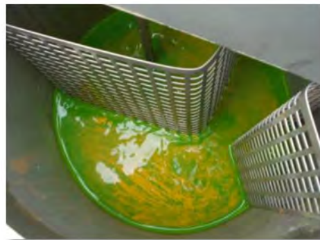
Elektrisch Angetriebene Rührwerk (Sichtkontrolle)
