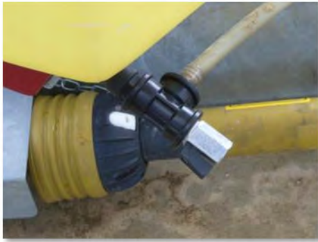
Zentraler Auslauf am tiefsten Punkt des Behälters
