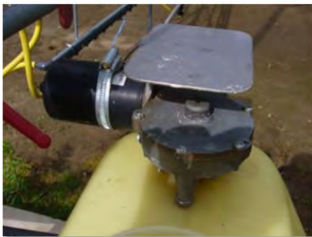
Elektrisch Angetriebene Rührwerk (Sichtkontrolle)
