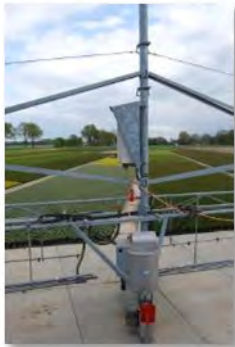
Weder Innen noch Außen am Behälter ist eine Füllstandsanzeige vorhanden
