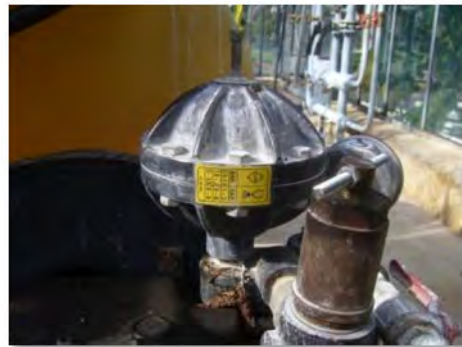
Dämpfung über Windkessel (ist auf den Spritzdruck anzupassen)
