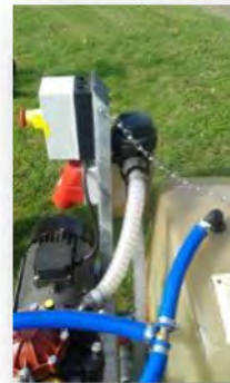
Bei Beschickung über Karrenspritze muss auch ein Saugfilter vorhanden sein
