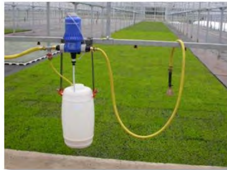
Weder Innen noch Außen am Behälter ist eine Füllstandsanzeige vorhanden
