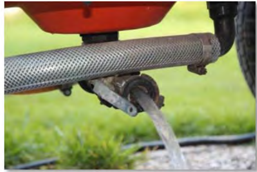
Zentraler Auslauf am tiefsten Punkt des Behälters
