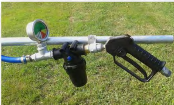
Hier kann das Handventil als Zentralabschaltung gewertet werden, da nur 1 Teilbreite bei diesem Gerät vorhanden ist
