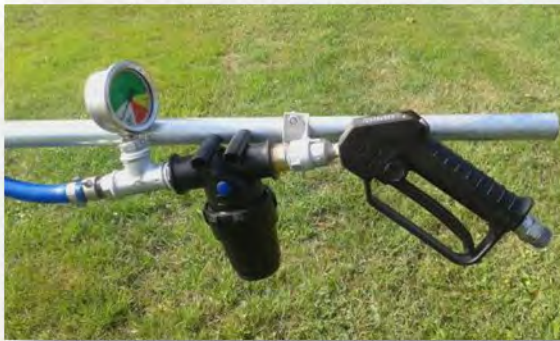
Spritzbalken/Teilbreite(n) über Handventil(e) geschaltet
