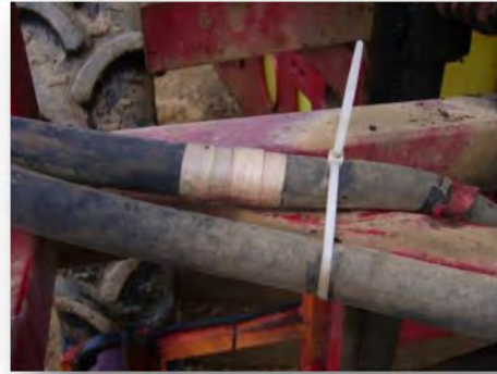
Schlauchhaspeln müssen komplett abgerollt sein, um evtl. „Flickstellen“ zu sehen
