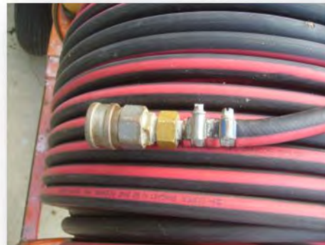
Schlauschellen bei Hochdruckschläuchen geht nicht (⇒ müssen verpresst werden)
