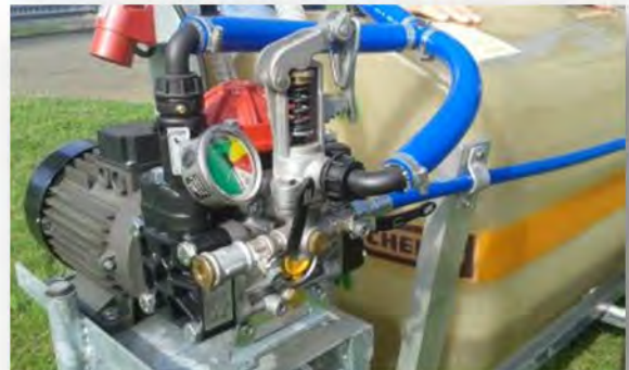
Voreinstellung an der Spritze möglich, aber dann muss am Spritzbalken noch Zu-/Abschaltung möglich sein (siehe links)
