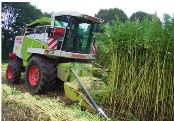
Abb. 7: Hanfernte mit dem Hemp Cut 3000
