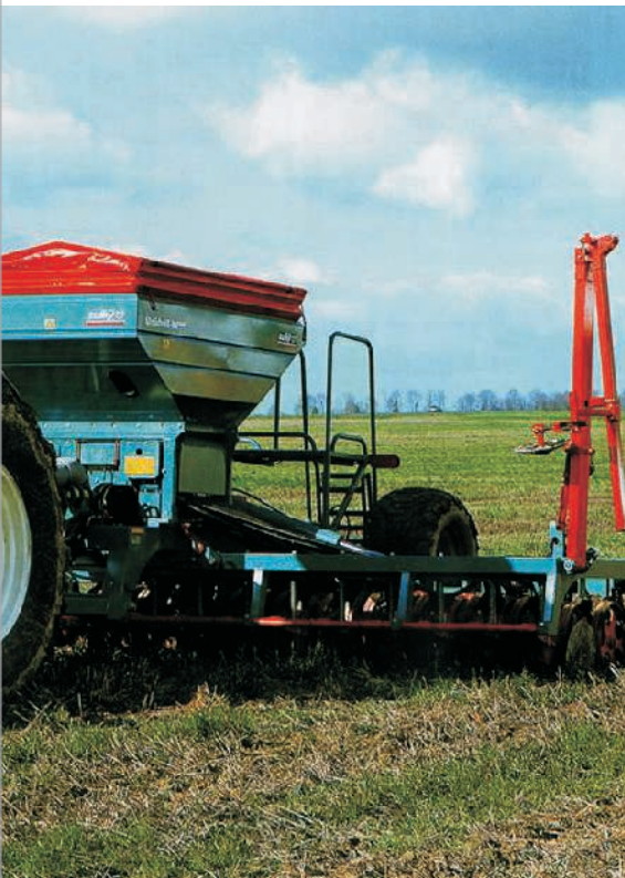
Bei Mulchsaatverfahren wird nur der obere Bodenbereich bearbeitet. Dadurch lassen sich zwischen 15 und 35 Liter Diesel pro Hektar im Vergleich zu Pflugverfahren einsparen
