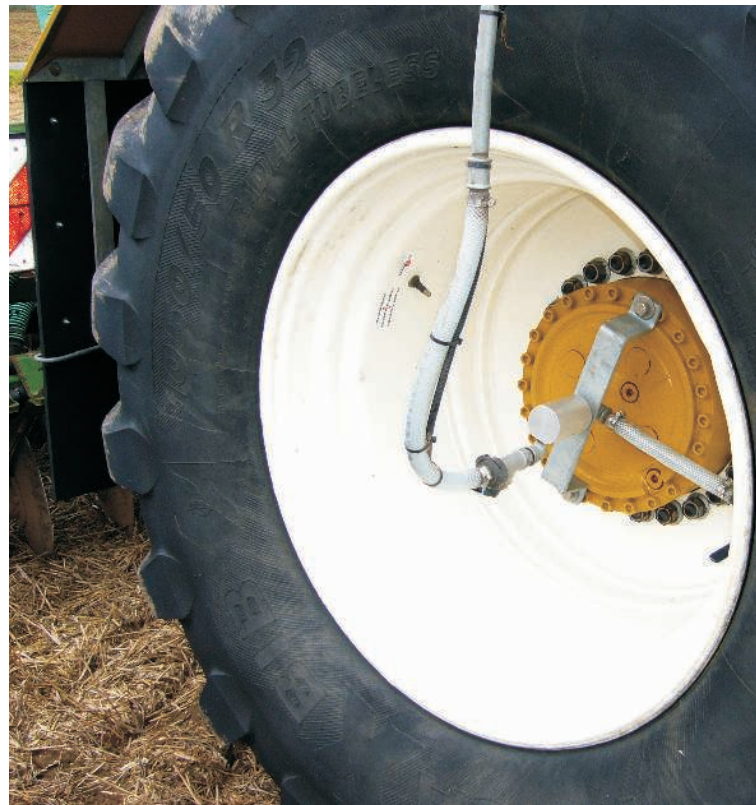
Reifendruckregelanlagen ermöglichen es, sowohl auf dem Acker als auch auf der Straße mit optimalem Reifennendruck und damit sehr dieselsparend zu fahren
