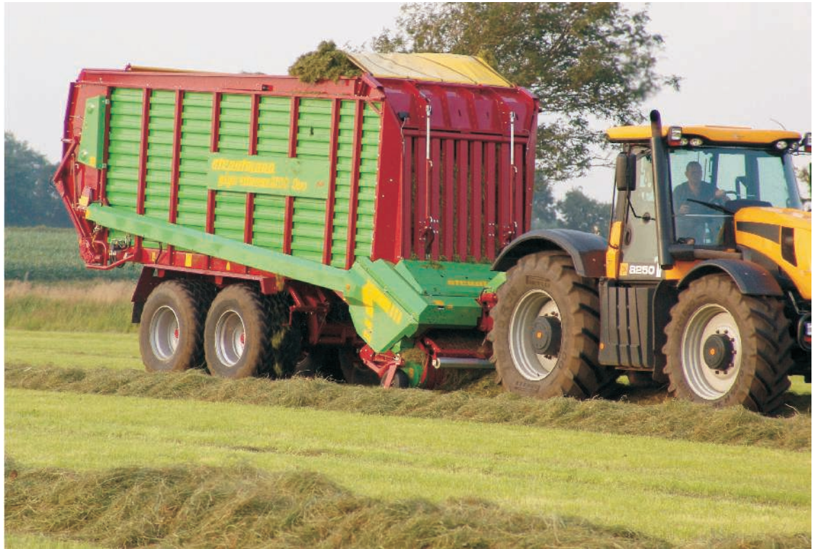
Allein durch stumpfe Messer im Ladewagen kann der Dieselverbrauch bei der Grasbergung um 15 Prozent erhöht werden
