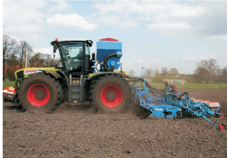
Auf dem Acker sind hohe und breite Reifen vorteilhaft, die mit niedrigem Reifennendruck gefahren werden können
