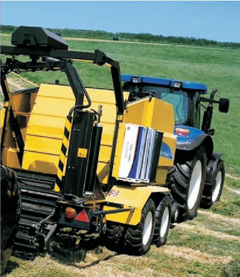
Rundballenpressen mit integriertem Ballenwickler verringern im Vergleich zum getrennten Pressen und Wickeln sowohl den Dieserverbrauch als auch den Arbeitszeitbedarf
