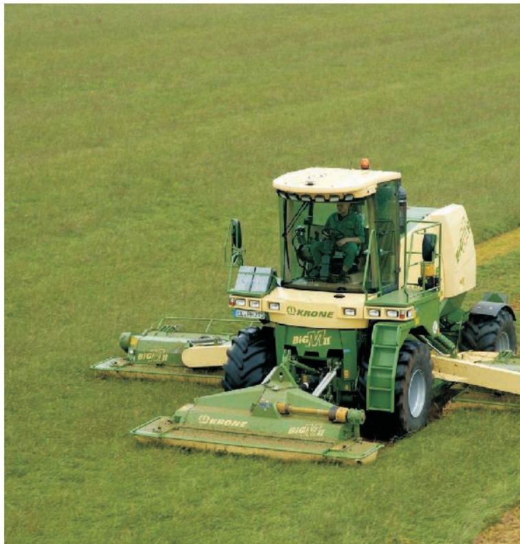
Das Mähen mit Aufbereitern ermöglicht eine deutliche Dieseleinsparung, wenn das Gras breitflächig abgelegt wird
