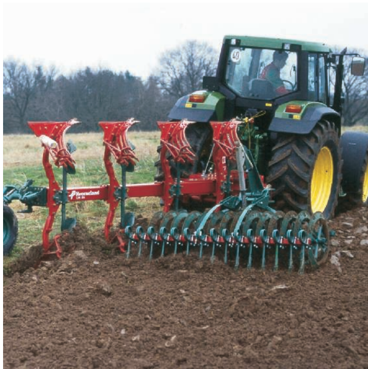
Auch beim Pflügen kann Diesel eingespart werden. Pflüge mit integrierten Packern bieten hierzu gute Möglichkeiten
