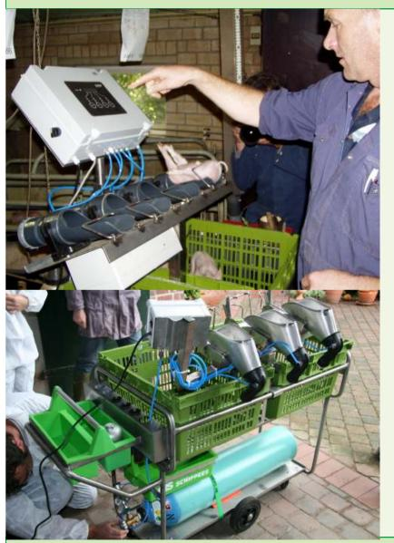
Verschiedene Ausführungen des Apparates für die CO<sub>2</sub>-Betäubung
