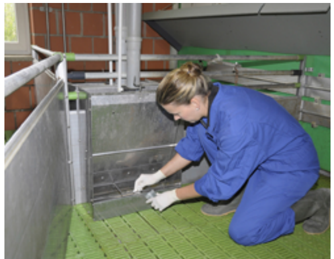
Der Reinigungserfolg lässt sich mit Abklatschproben kontrollieren.
