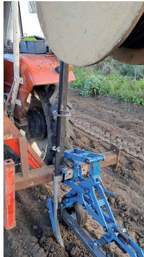
Abb. 2: Verlegeeinheit mit Tropfschlauchtrommel am oberen Bildrand
