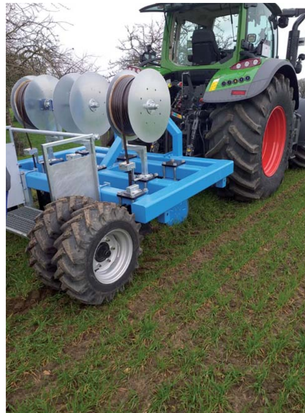
Abb. 3: Einzug der Tropfschläuche zweireihig in 75 cm Abstand im März 2023 im Weizenbestand; alle Fotos: J. Gütschow
