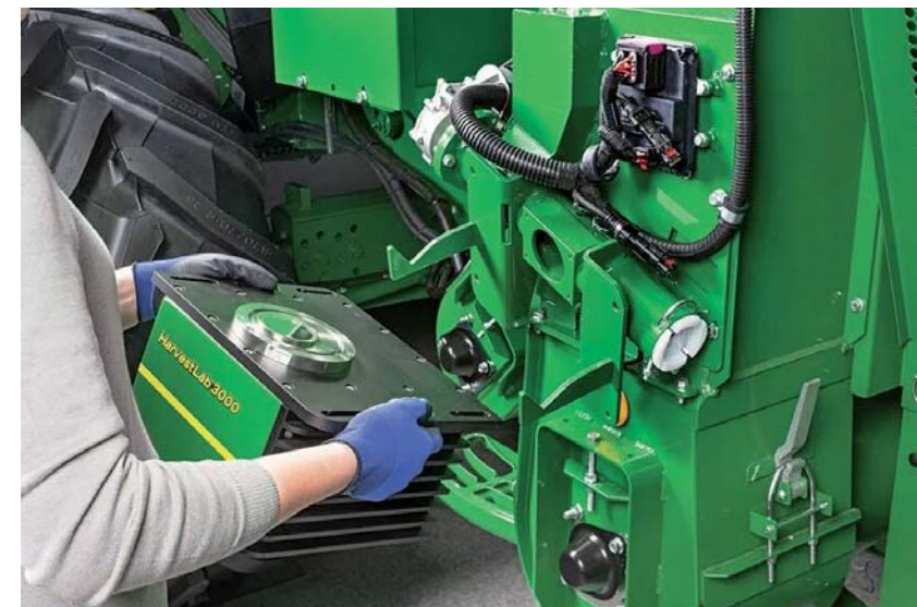
Abb 1: NIRS-Sensor beim Einbau am Körnerelevator des Mähdreschers für das sogenannte „Grain-Sensing“
