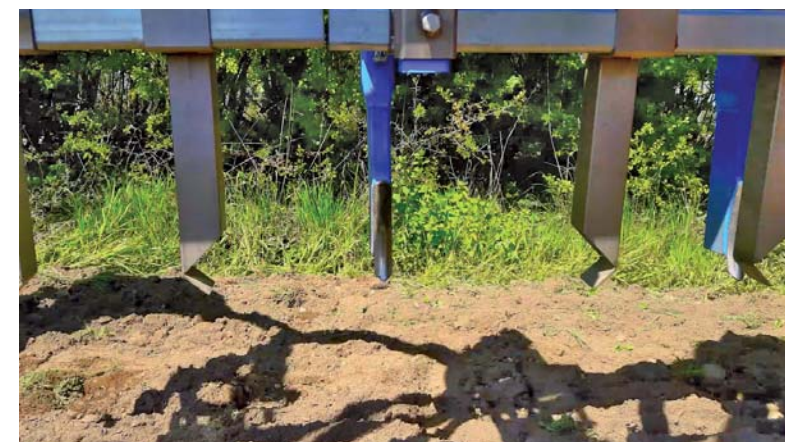
Abb. 1 Aufbau: links und rechts Prallbleche, mittig Düngeschar
