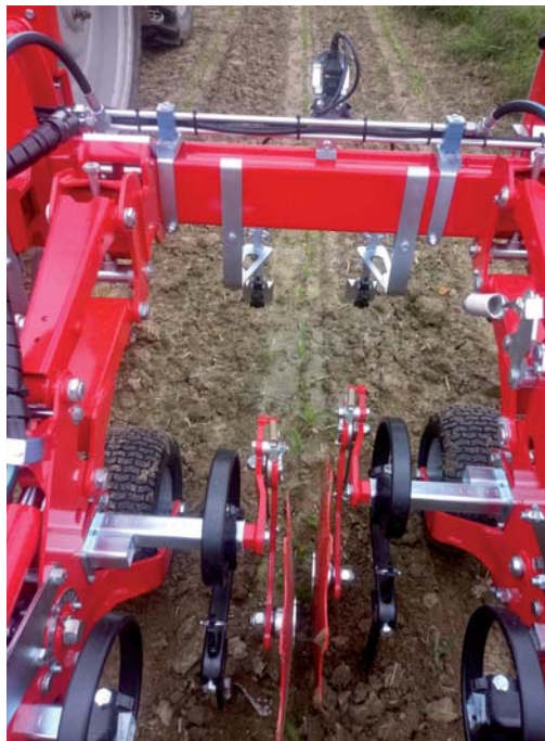
Abb. 1: Bandspritzereinheit an kamerageführter Hacke zum Bandspritzen im kombinierten Verfahren
