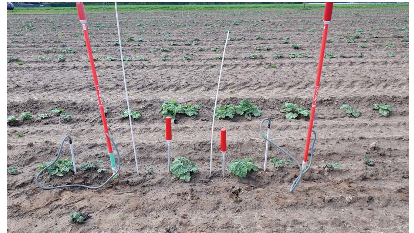
Abb. 2: Verschiedene Varianten der Bodenfeuchtesensoren des Herstellers PlantCare AG mit unterschiedlichen Einbautiefen in einem jungen Rhabarberbestand
