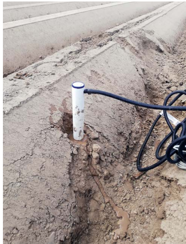
Abb. 1: Sentek D&D Bodenfeuchtesonde, eingebaut in Kartoffeldamm
