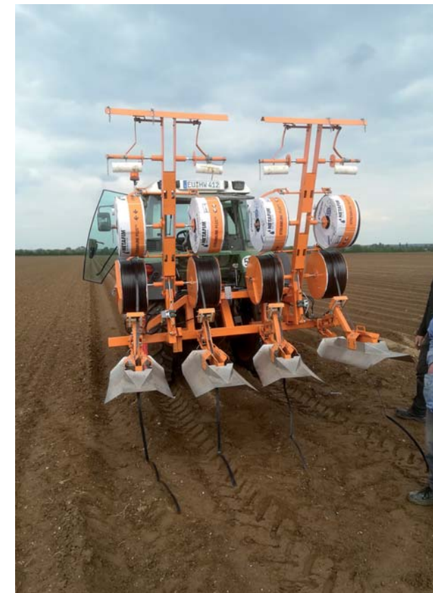
Abb. 1: nachträgliches Einziehen der Tropfschläuche in den Damm
