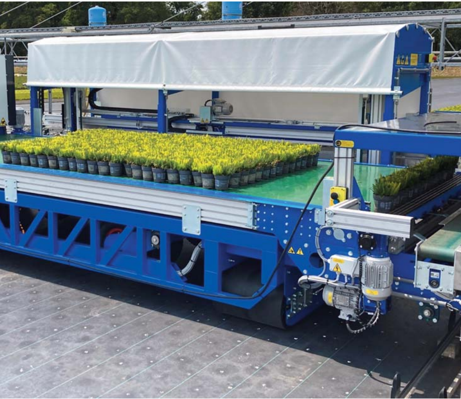
Abb. 8: Exaktgießwagen mit Absetzroboter
