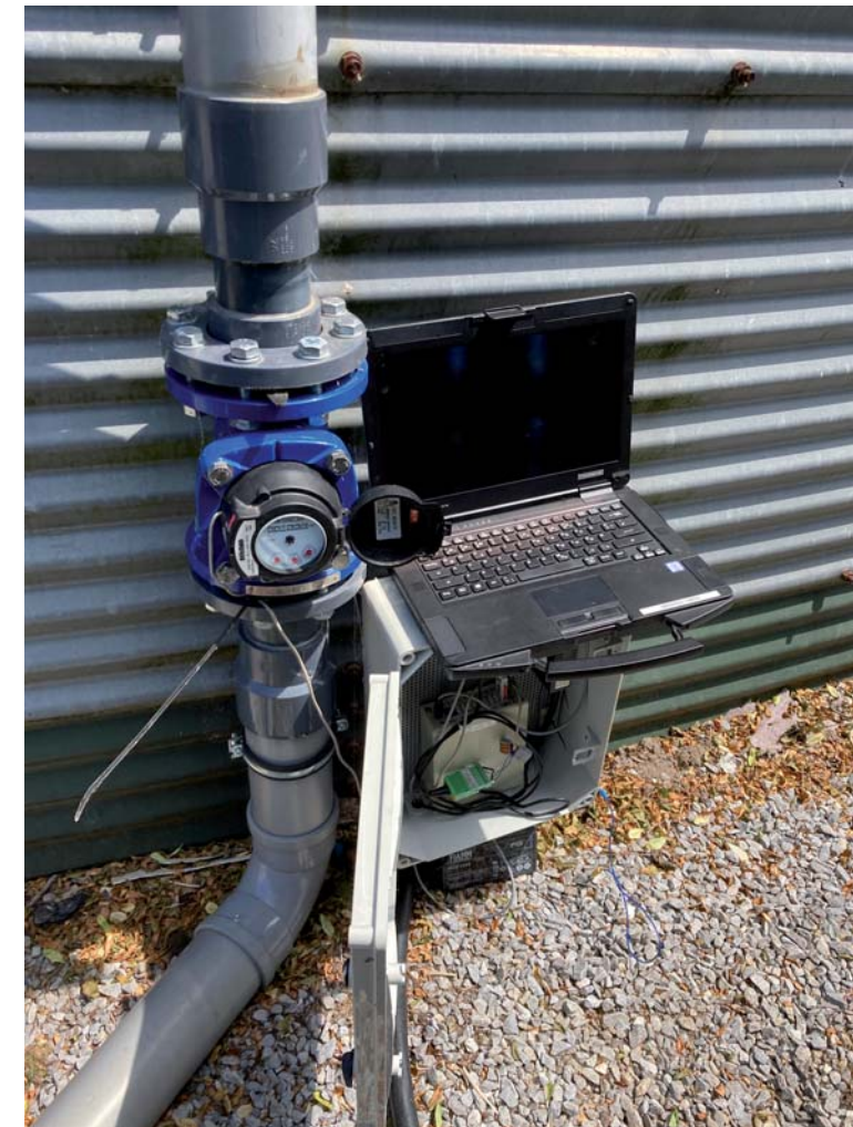
Abb. 11: Volumetrische Messung und Auswertung des zurückgeführten Drainwassers
