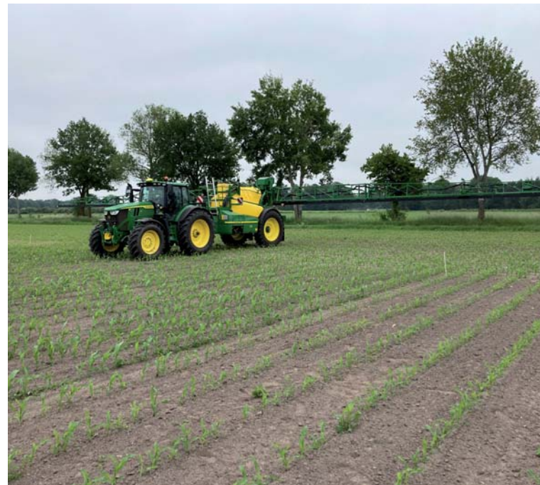
Abb. 2: Anhängerpflanzenschutzspritze mit 25 cm Düsenabstand zum Bandspritzen im absätziges Verfahren. Nach der Bandspritzung erfolgt zum passenden Zeitpunkt der gesonderte Hackgang
