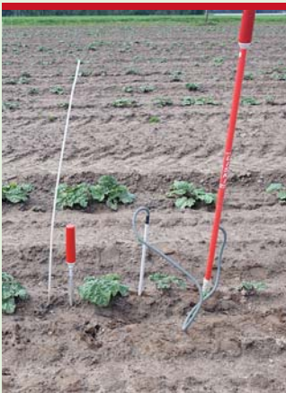
g. Messstation mit Bodenfeuchtsensor
