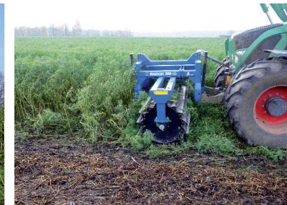
Messerwalze im Einsatz
