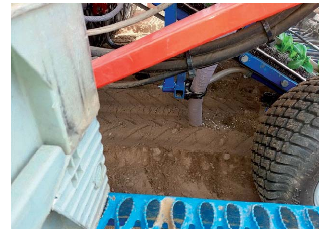
Schlauchleitung zur Ablage des Düngebandes
