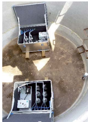
Unterdruckregelung mit Sammelflaschen des Sickerwassers für die zwei Saugplattenanlagen
