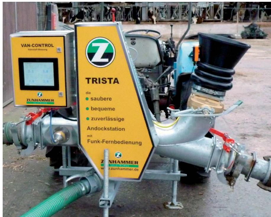
Andockstation zwischen Güllebehälter und Güllefass zur Bestimmung der Inhaltsstoffe
