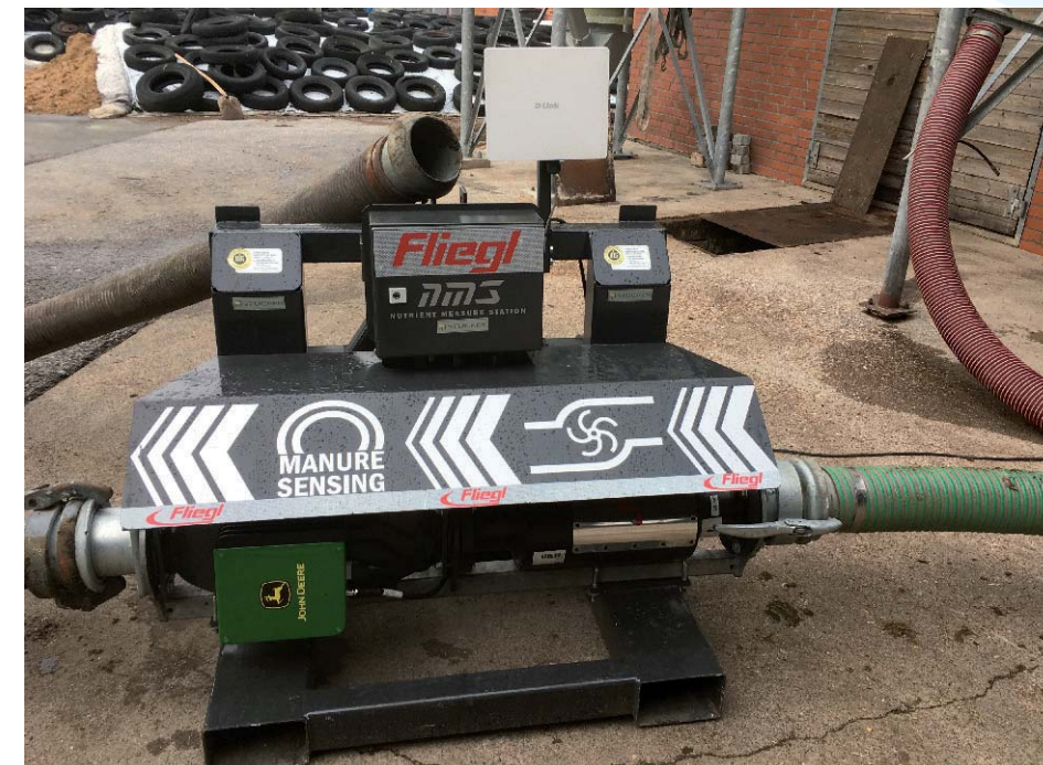
Andockstation zwischen Güllebehälter und Güllefass
