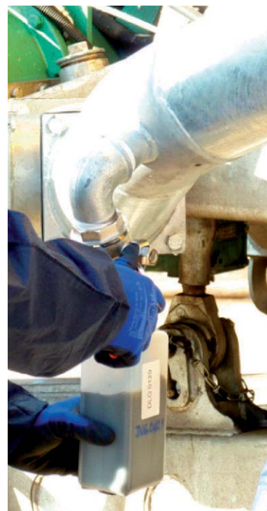
Probenahme an der Andockstation
