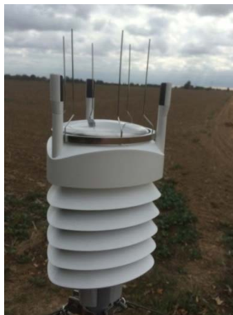
Abb. 174: Vaisalla-Sensor (oben) und Windsensor der Wetterstation
