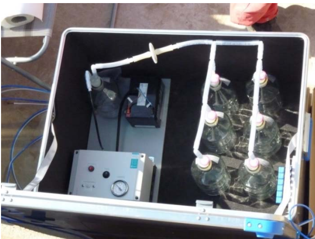
Abb. 172: Einblick in eine Kiste im Sammelschacht: 6 Sammelflaschen für Sickerwasser mit Unterdruckpumpe und Akku; die siebte Flasche dient der Sicherheit der Pumpe bei evtl. Überlauf einer Flasche
