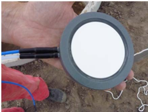
Abb. 168: Saugplatte mit zwei Schlauchanschlüssen für die Belüftung bei Probeentnahme
