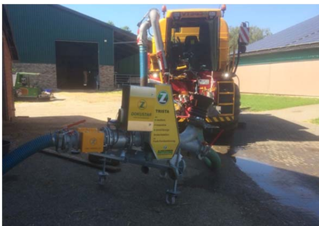
Abb. 155: Andockstation mit neuem Sensor und Durchflussmesser im Einsatz
