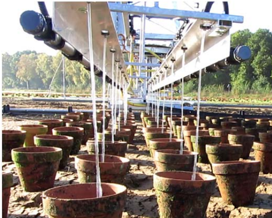
Abb. 154: Exaktgießwagen - gezielte Bewässerung und Düngung der Töpfe
