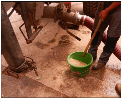
Abb. 128: Einsaugen der trockenen Grassamen beim Ansaugen der Gülle
