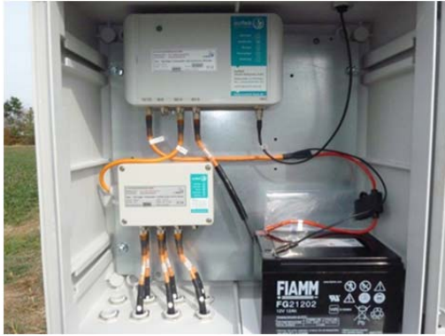
Abb. 175: Einblick in eine Wetterstation, rechts: Akku, links: Eingang Tensiometer, oben: Datenlogger mit SIM-Karte für Datentransfer zum GD
