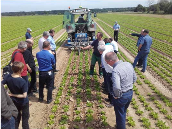
Abb. 146: Demonstration der kameragesteuerten Reihenhacke im Salatanbau
