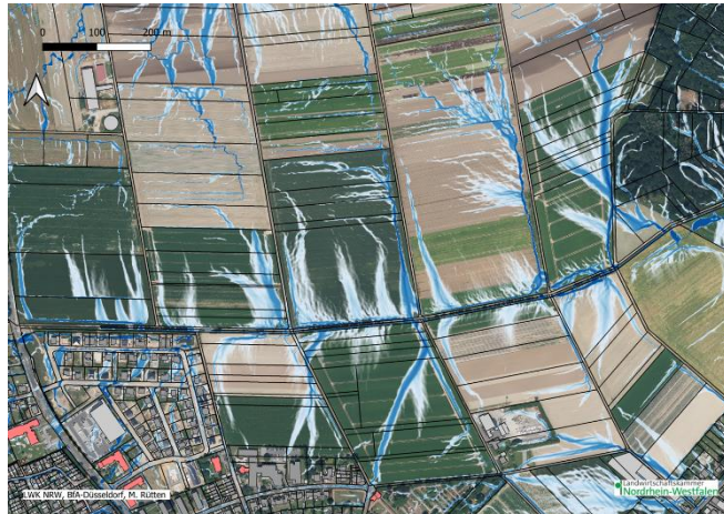
Abb. 9: Modellierung des Niederschlagsabflusses im Bereich Lehmkuhlgraben
