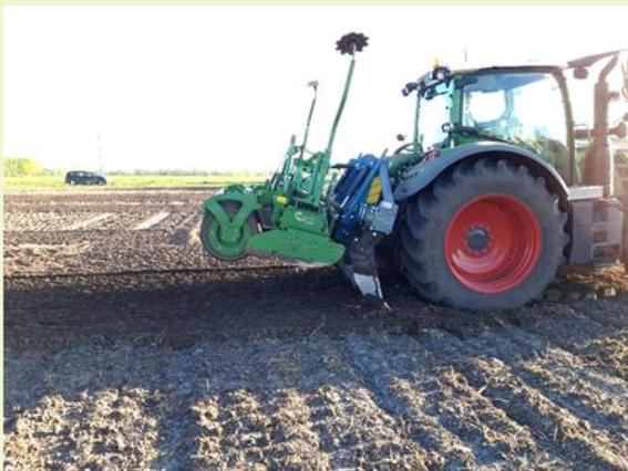
**Abb. 1: Saatbettbereitung für Mais mit einer Kombination aus Streifenlockerer und Kreiselgrubber. Der Boden wurde bis in Pflugtiefe gelockert aber nicht gewendet.**
