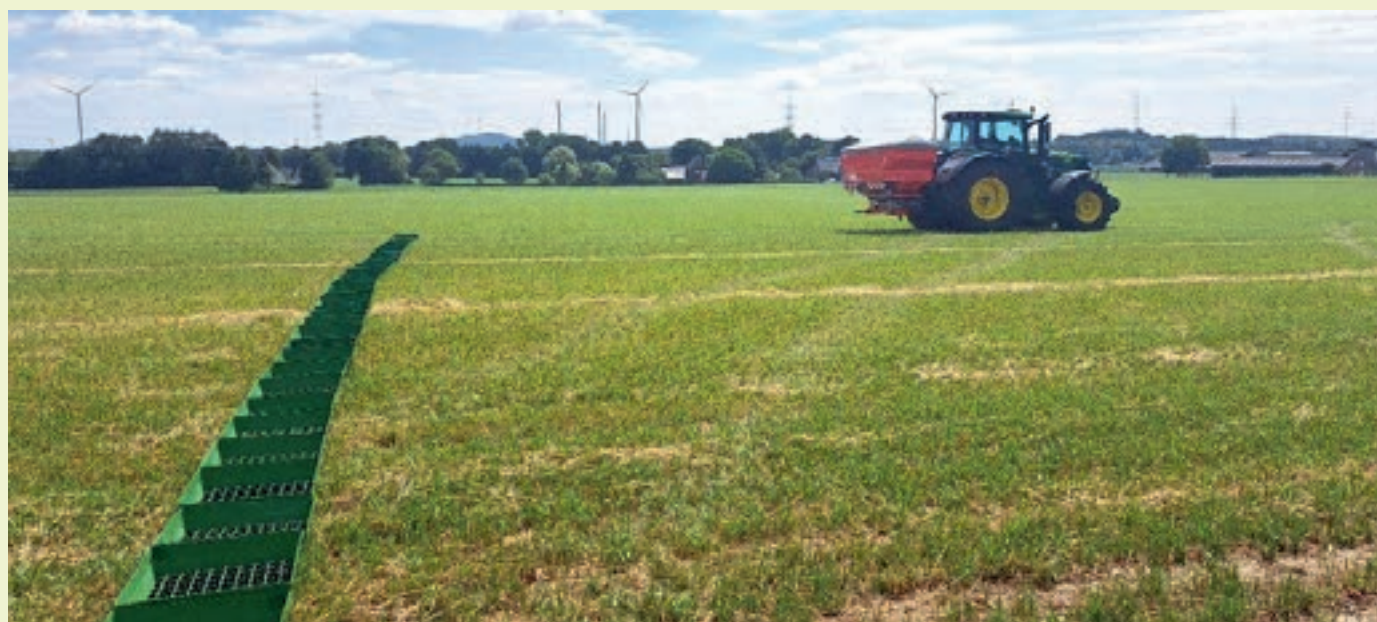
Abb. 1: Versuchsaufbau zum Düngerstreuertest
