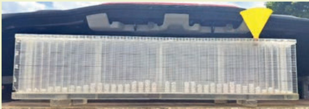
Abb. 3: Streubild Breitverteilung mit Randstreueinstellung
