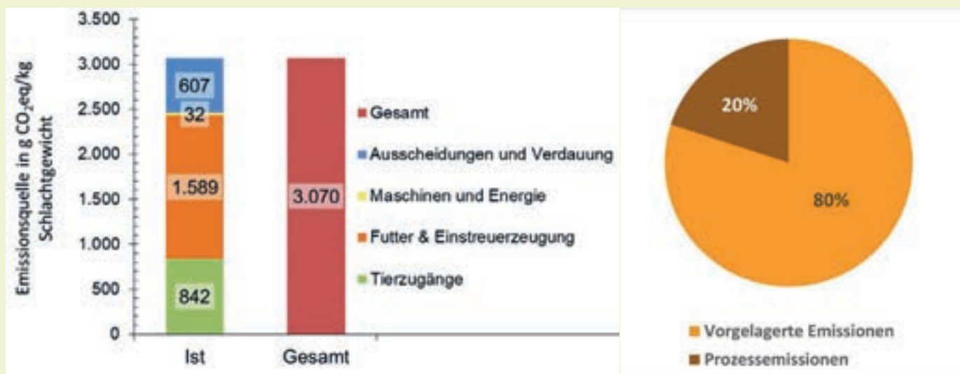
Abb. 1: Emissionsquellen in der Schweinemast Beispielbetrieb (Quelle: Klimaschutzstudie zu landwirtschaftlichen Treibhausgasemissionen LWK NRW 2024)
