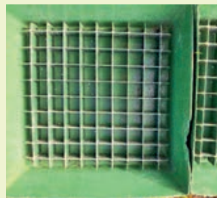
Abb. 2: Schalen zur Überprüfung des Streubildes beim Dynatest
