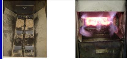
Abbildung xx: einzige Quereinschubfeuerung (links), Brennraum des Compact C4 (rechts)
