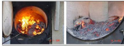
Abbildung 30: Ausbrandphase (links), Glut nach Ausbrandphase (rechts; [Quelle beide SLUG])
