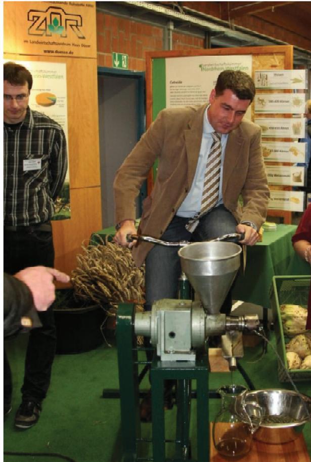
**Abbildung VI-6:** Mit Pedal- und Muskelkraft werden aus Rapskörnern Rapsöl und Rapskuchen
