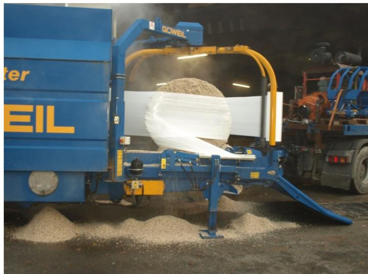
Abbildung 17: Herstellung eines Wickelballens aus Zuckerrübenschnitzeln
