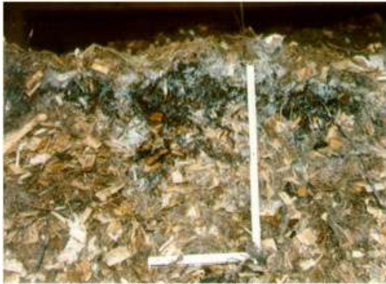
Schimmelbildung an der Schüttungskrone
