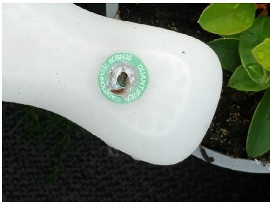
Abbildung 15: Schaden durch Vogelpicken an der Membran
