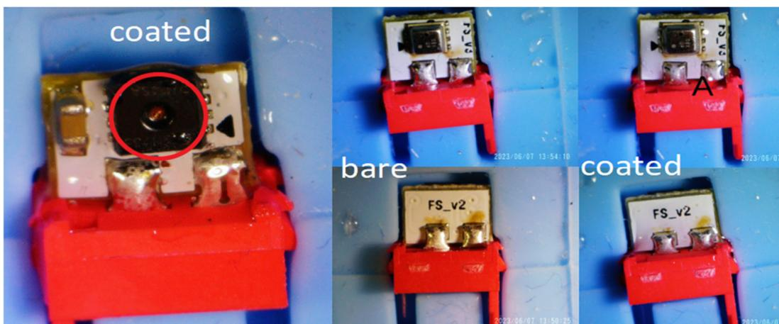
Abbildung 20: Membran mit Ummantelung (links und rechts, ohne Ummantelung in der Mitte)
