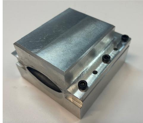
Abbildung 6: Prototyp einer Aluminiumgussform zum Gießen der Leiterplatte
