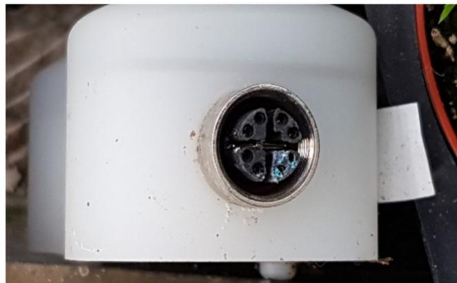
Abbildung 16: Korrosion am Connector durch Kondenswasser
