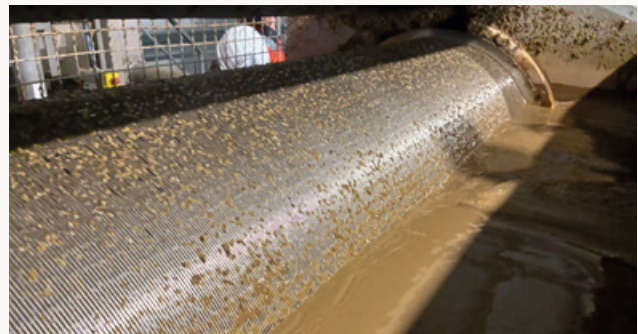
Alles, was zurück auf den Acker kommt, muss in der Zuckerfabrik von Pfeifer & Langen in Lage durch ein 0,5 mm großes Sieb. Bild: Günter Klingenhagen
