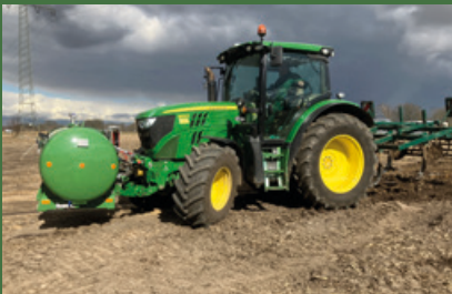
Onland-Hochdruckreiniger für die schnelle Reinigung am Feld. So kann eine Verschleppung von Feld zu Feld verhindert werden.
