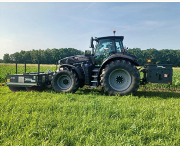
Eine Behandlung des Erdmandelgrases mit Strom ist sehr kostenintensiv. In unseren Versuchen sind 50 % der Mandeln, die sich unter einer abgetöteten Pflanze befanden, wieder ausgetrieben.
