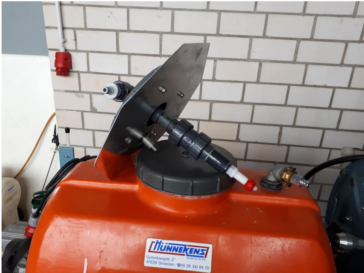
Karrenspritze mit angepasster Innenreinigungsdüse und Rückschlagventil (H. Kramer)
