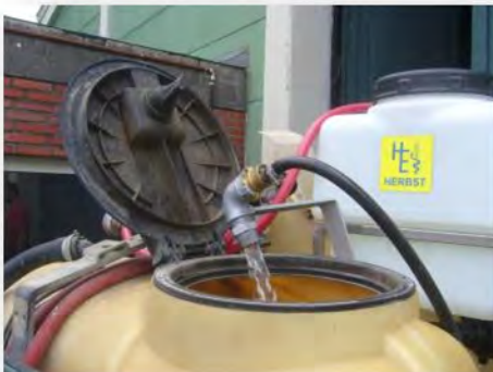
Lücke zwischen Befüllung und Fass
