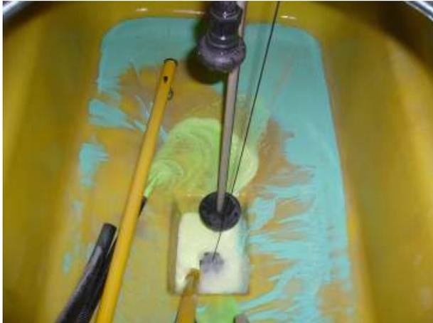
Falls der Rücklauf während der Spritzung geschlossen wurde, muss darauf geachtet werden, dass dieser zumindest teilweise geöffnet wird um alle Leitungen zu reinigen. Ebenfalls muss bei den Umlaufsystemen darauf geachtet werden, dass die Düsen kurz geschlossen werden, damit das Umlaufsystem während des Reinigungsvorganges aktiviert wird. Bei
