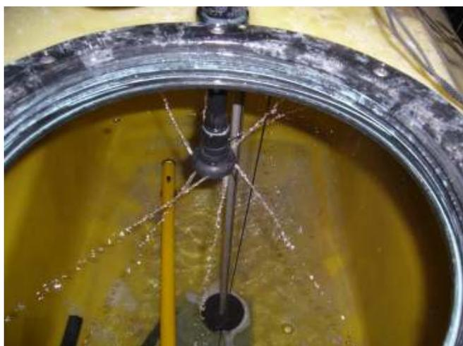
Feld identifiziert werden. Hierbei geht der Anwender nicht den Weg des mehrfachen Verdünnens, sondern er „drückt“ die technische Restmenge mit dem auf der Spritze vorhandenen Klarwasser kontinuierlich aus der Spritze. Voraussetzung hierfür ist eine zusätzliche Pumpe, die das Klarwasser direkt über die Innenreinigungsdüse in den Spritzentank einleitet. Diese Pumpe kann bei kleineren Spritzen oder Sprühgeräten elektronisch über die Schlepperelektrik angeschlossen werden. Bei
