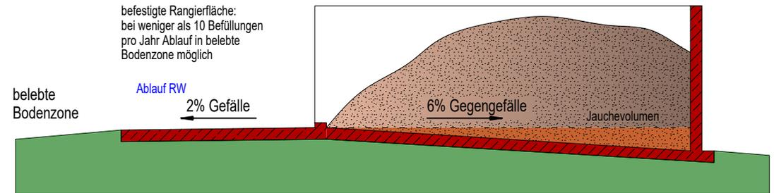
Querschnitt Festmistlager in wannenförmiger Ausführung
