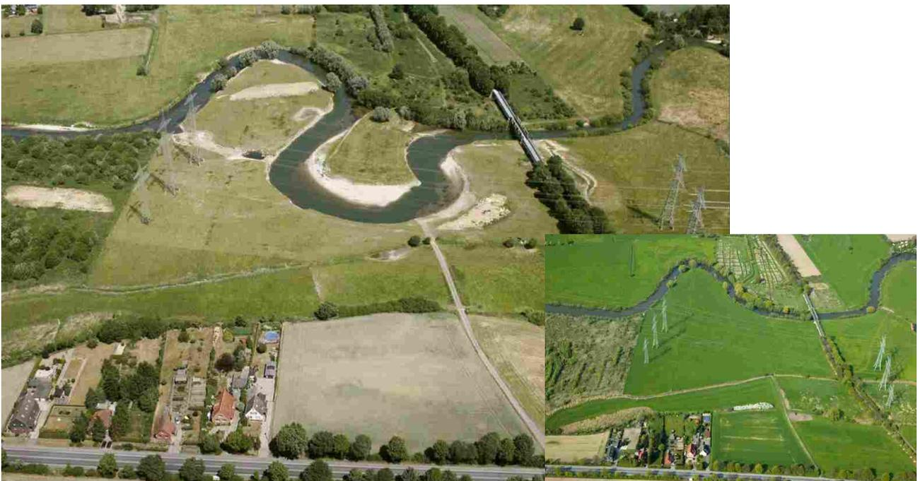
Laufverlängerung mit Anlage einer neuen Lippeschlinge im Maßnahmenbereich D (großes Foto), Zustand vor Maßnahmenumsetzung (kleines Foto)
