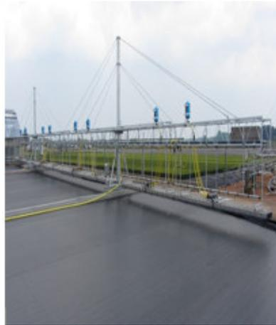
Weiterentwickelter Exaktgießwagen für 10er Töpfe, ausgelegt für einen Hektar pro Arbeitsgang
