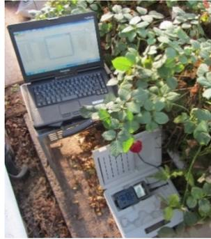
Messung der EC- und Temperaturwerte in Drainagewässern bei Rosen
