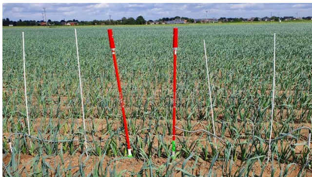
Abb. 2: Bodenfeuchtesensoren in Porree Foto: Simon Keutmann
