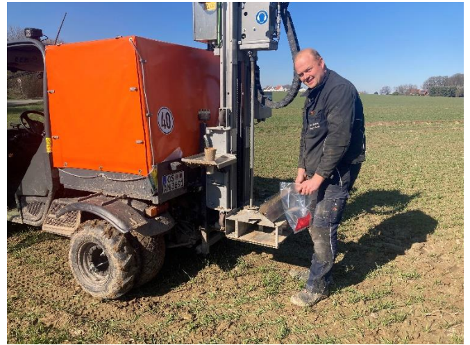
Mit seinem Spezialfahrzeug zieht Probenehmer Nicolas Abing im Wasserschutzgebiet Bodenproben. Nach der Entnahme tütet Abing die Proben von Hand ein.
