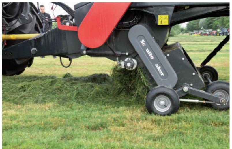
Die gezogene Pickup ist besser als ihr Ruf. Schwere Fremdkörper können während der Aufnahme noch von den Zinken fallen. Die führenden Stützräder können nah an den neuralgischen Punkten angebracht sein und so für eine „saubere“ Aufnahme sorgen. Der Bereich Aufnahmeleistung und Durchsatz ist vergleichbar mit der geschobenen Pickup.
