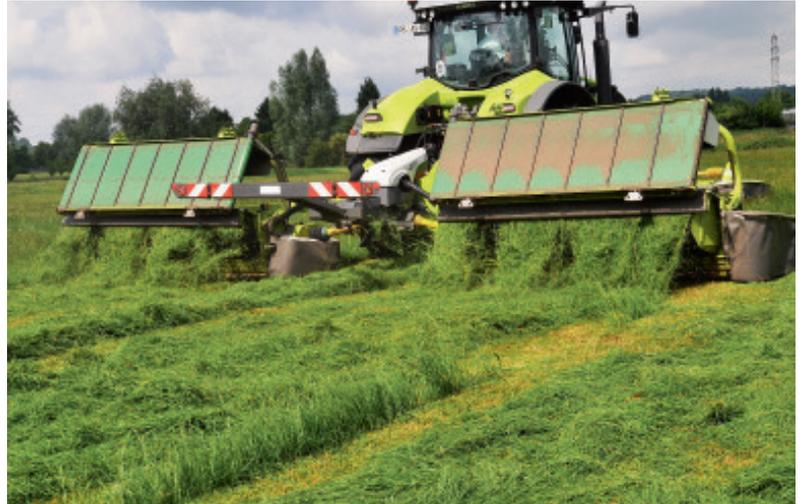
Für Lohnunternehmer bieten sich die Schmetterlingsmäherwerke mit Aufbereiter in Kombination mit Bandablage an. Im Grünroggen und bei bescheidenen Aufwuchsmengen im Gras sind Schlagkraft, Kosteneinsparungen und schmutzarmes Futter entscheidende Argumente, zumal diese Technik nach Bedarf eingesetzt werden kann.
