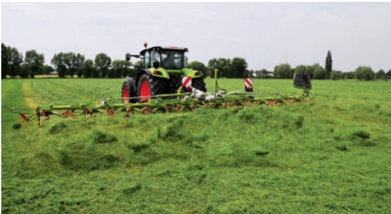
Zetten bedeutet das gleichmäßige Verteilen des Mähgutes ohne Haufenbildung mit Knickeffekten. Die ideale Arbeitsgeschwindigkeit beträgt dann 6 bis 7 km/h. Große Arbeitsbreiten mit hohen Arbeitsgeschwindigkeiten von 10 bis 12 km/h beim Mähen erfordern Arbeitsbreiten beim Zettwender, die fast an die doppelte Arbeitsbreite der Mähkombination heranreichen. Dann sind Maschinen mit zehn Kreiseln und 11 m Arbeitsbreite im Dreipunkt keine Besonderheit mehr.
