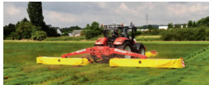
Schlagkraft ist auch bei der Eigenmechanisierung Mähen kein Fremdwort mehr. Mit Arbeitsbreiten von 8,50 bis 11,20 m werden die Ansprüche der Praxis technisch angesprochen. Mit einem Leistungsbedarf ab 120 PS können die im Betrieb vorhandenen Schlepper eingesetzt werden. Für den folgenden Zettvorgang bietet eine Breitablage des Mähgutes ideale Voraussetzungen.
